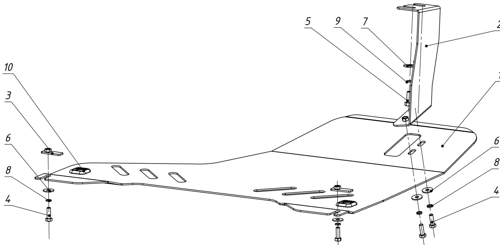
1. Выкрутить два штатных болта крепящие страховочную опору РК.
